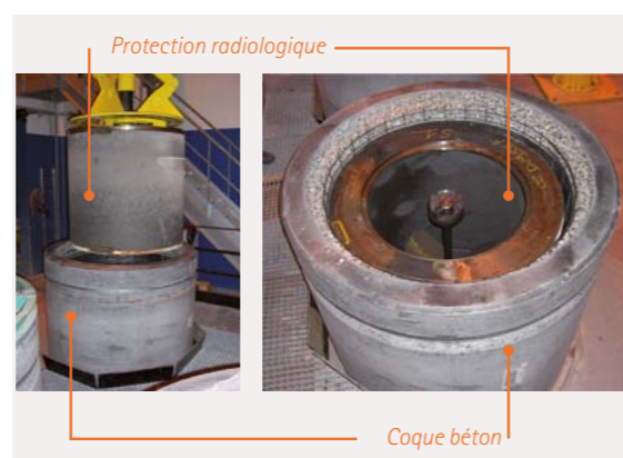
Valorisation par fabrication de Protections Radiologiques Intégrables.
